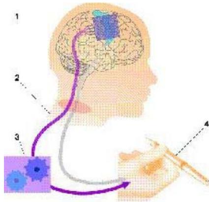
Funktion des BMI: (1) Elektroden messen die Gehirnaktivität. (2) System zur Datenübertragung der Signale an (3) ein abgestimmtes System aus Verstärker, Computer und lernfähiger Software zur Dekodierung eines Signals. (4) Effektor wie beispielsweise ein Computercursor, eine Arm- oder Handprothese oder die eigene Muskulatur, angesteuert durch direkte Muskelstimulation. (Abb. Mehring)
