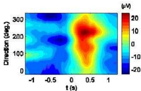
Abhängigkeit der Hirnaktivität von der Bewegungsrichtung des Arms. Farbkodiert ist die an einer Elektrode an der Hirnoberfläche gemessene lokale Aktivität des Gehirns als Funktion der Bewegungsrichtung (y-Achse) und der Zeit (x-Achse). Zum Zeitpunkt  $t=0$  beginnt die Bewegung. (Abb.: Mehring)
